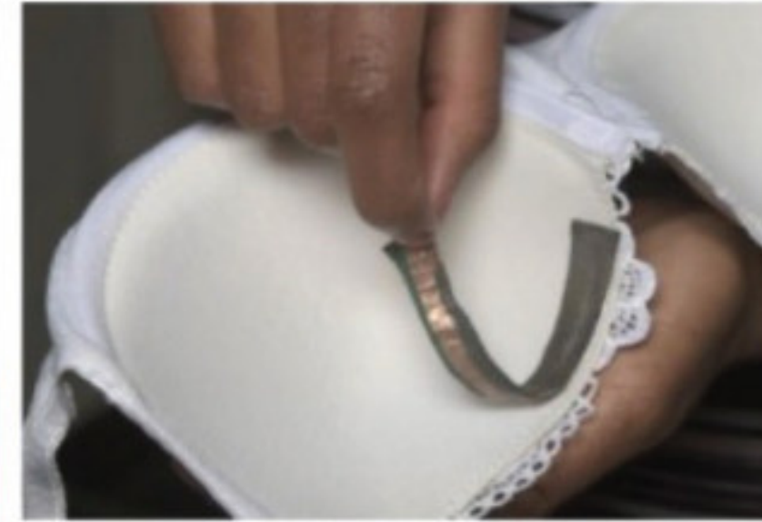
สติ๊กเกอร์เซนเซอร์ที่จะส่งสัญญาณเตือนเมื่อมีแรงกระชาก (2017), สหรัฐฯ
