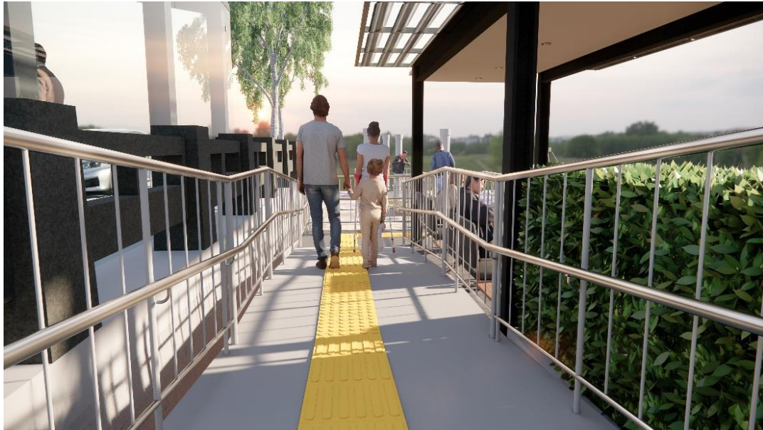
ภาพที่ 25 ทางลาด 1:12 พร้อมราวจับสองระดับสูง 1 เมตร
