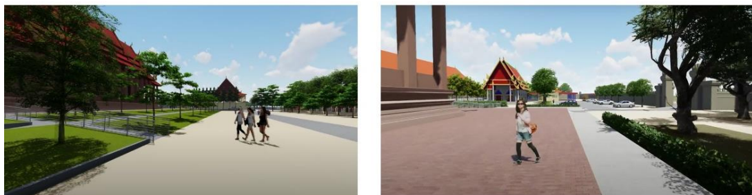
ภาพที่ 72 การใส่ภาพคนในภาพทัศนียภาพ ช่วยให้สามารถเปรียบเทียบขนาดพื้นที่นั้น ๆ ได้ง่ายขึ้น โดยอาศัยการเปรียบเทียบขนาดของพื้นที่นั้นกับสัดส่วนของคนในภาพ
