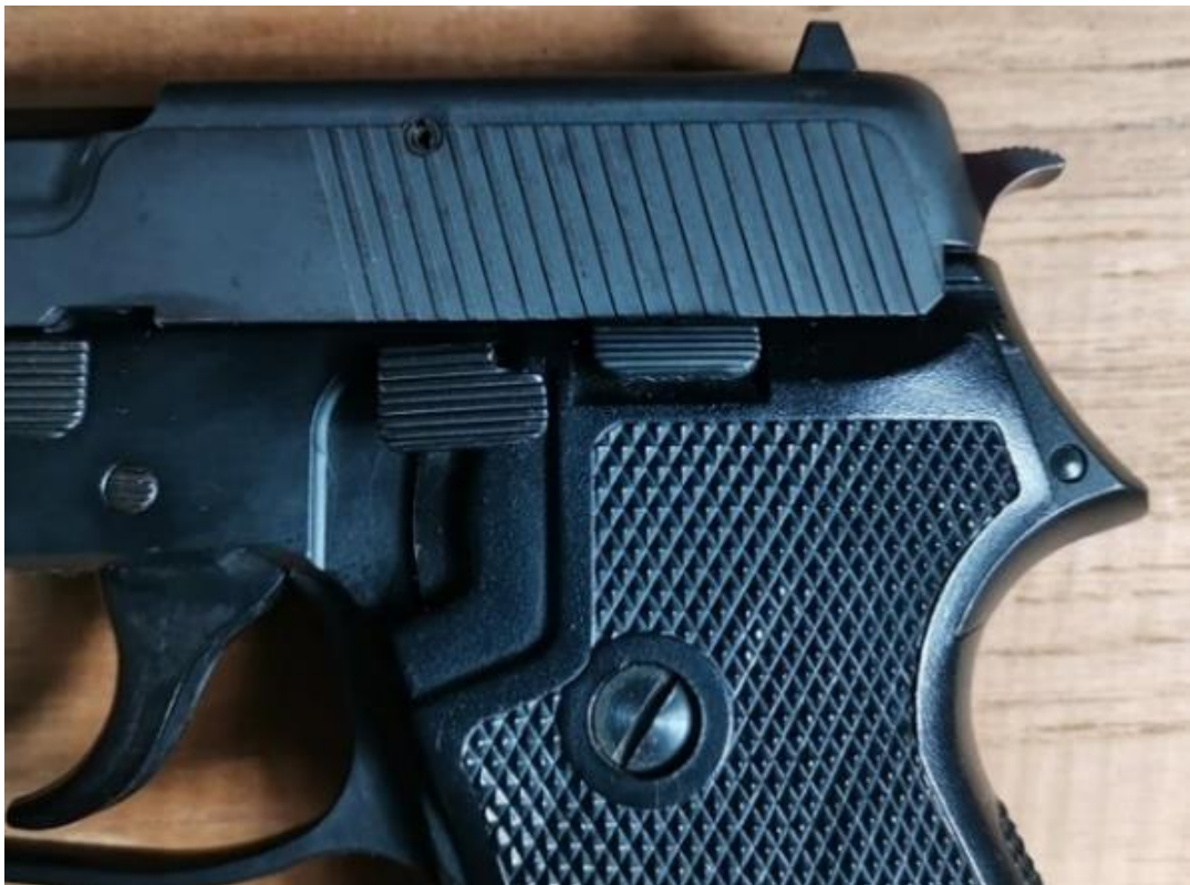
ภาพที่ 81 คันลดนกลีบและคันแขวนสไลด์ ปืน P220 บันทึกเมื่อ 10 ธันวาคม 2564
